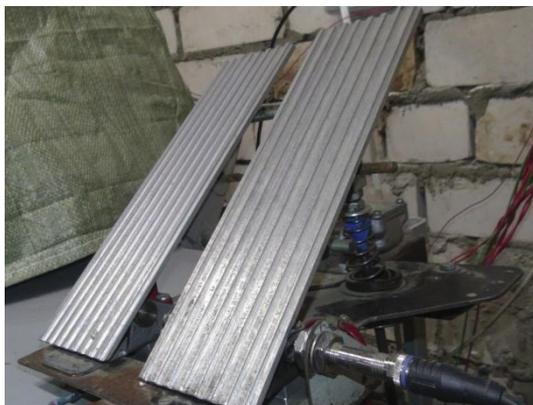
**Рис. 2. Имитатор педали газа автомобиля**
