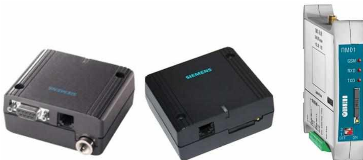
Рис. 2. GSM модемы фирмы Siemens (слева) и ОБЕН (справа)
