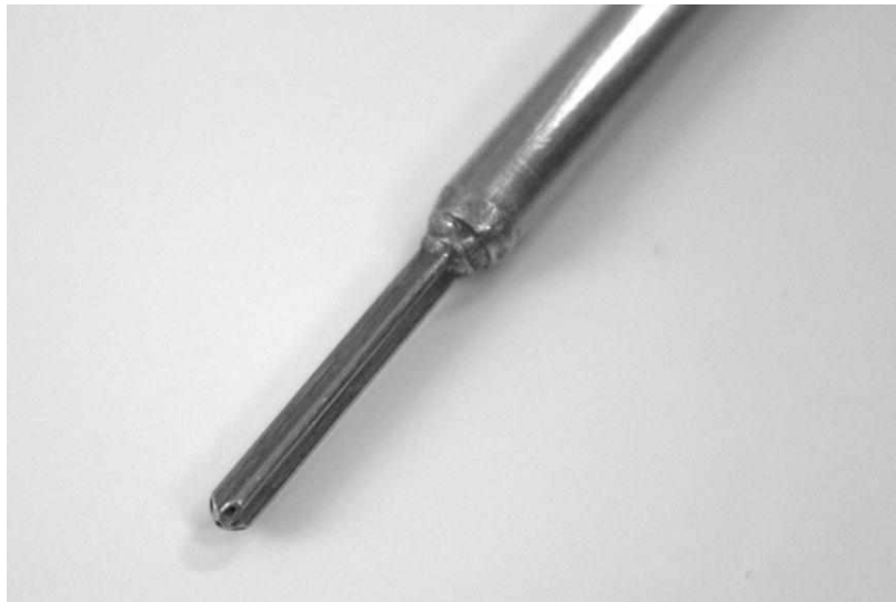
Рис. 3. Чувствительная часть пятиканального пневмометрического зонда
