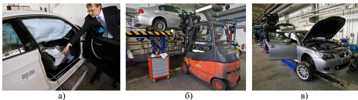
Рис. 7. Переработка вышедших из эксплуатации транспортных средств в Германии: а – подрыв пиропатронов на специальном стенде с помощью пульта внешнего управления; б – слив жидкостей; в – демонтаж
