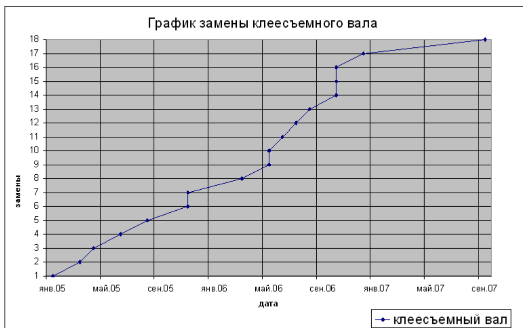
Рис. 3. График замены клеесъемного вала
