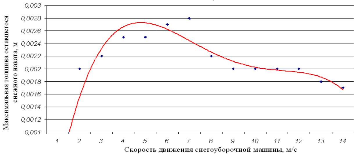
Рис. 5. Изменение максимальной толщины неудалённого снежного наката от скорости движения снегоуборочной машины
