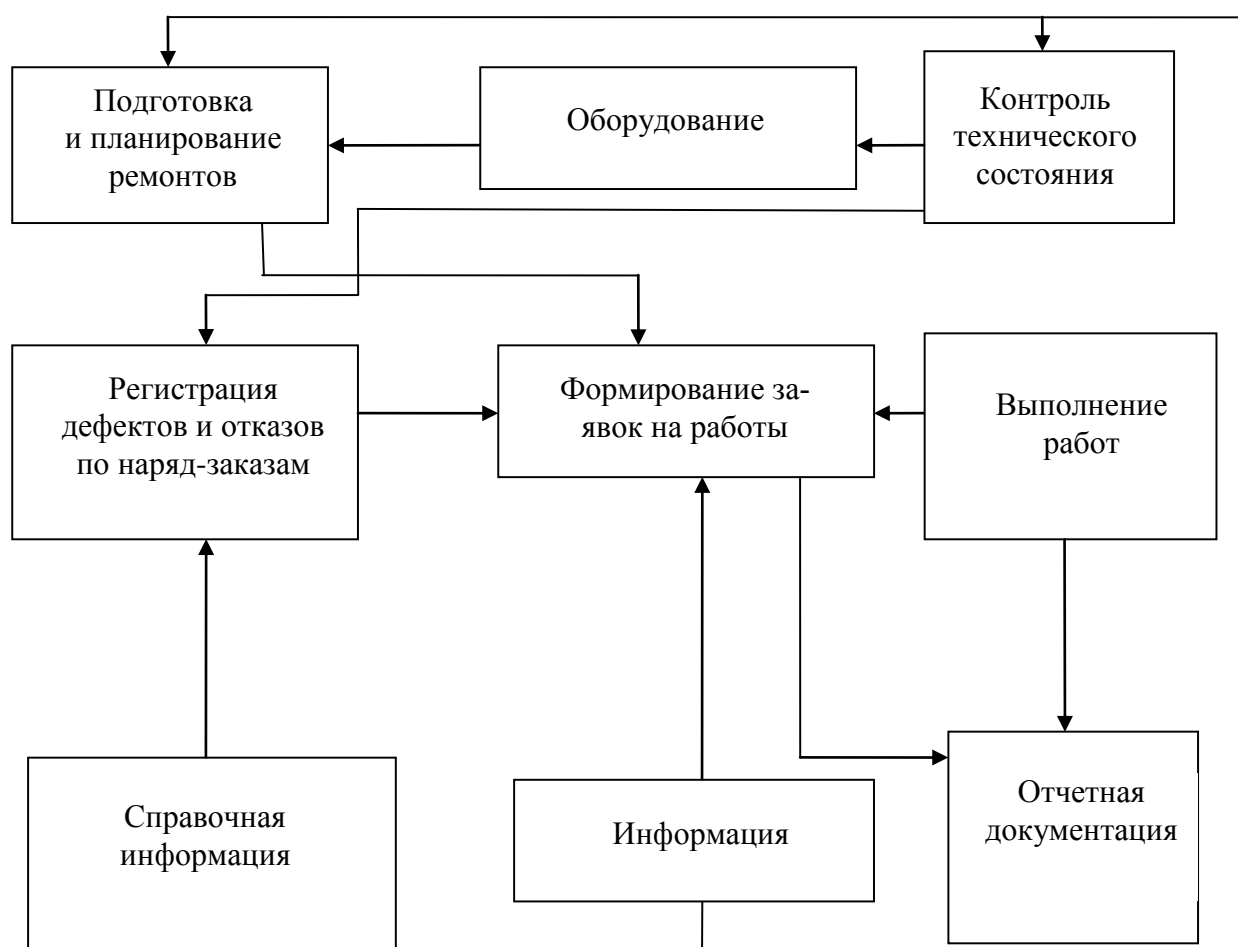
Рис. 1. Схема автоматизированной системы планирования ремонтов и поставок запасных частей
