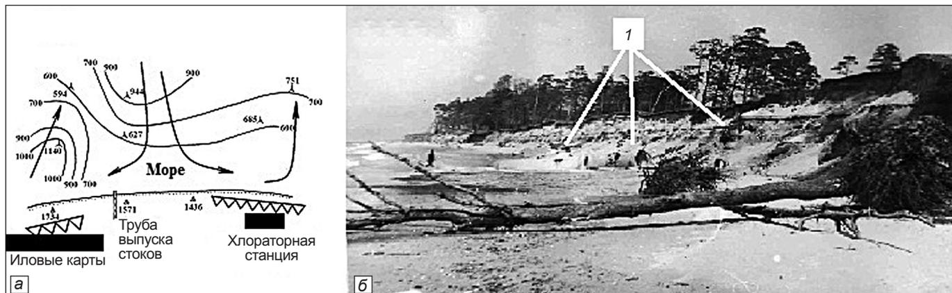
Рис. 3. Угрозы и разрушения штормовой абразией токсичных объектов системы городской канализации Лиепай: а – объекты городских очистных сооружений, местечко Шкедес. Стрелки – прибрежные течения. Изолинии и цифры – концентрации взвесей, г; б – фрагменты магистрали коллектора стоков: 1 – обрушение на пляж труб магистрали.
